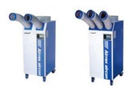
Le **HSC 2500/3500** est un climatiseur mobile industriel qui vous permettra de refroidir des locaux et des process industriels. Idéal pour faire du « spot cooling », sa fiabilité est à toute épreuve. Grâce à sa ventilation centrifuge, il est possible de rallonger les gaines de soufflage. L'air chaud est évacué par le dessus de l'appareil (gainage possible pour évacuer vers l'extérieur).
