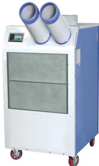
Le **HSC 3600B** est un climatiseur mobile industriel qui vous permettra de refroidir des locaux et des process industriels. Idéal pour faire du « spot cooling », sa fiabilité est à toute épreuve. Grâce à sa ventilation centrifuge, il est possible de rallonger les gaines de soufflage. L'air chaud est évacué par le dessus de l'appareil (gainage possible pour évacuer vers l'extérieur).
