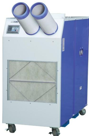
Le **HSC 5000A** est un climatiseur mobile industriel qui vous permettra de refroidir des locaux et des process industriels. Idéal pour faire du « spot cooling », sa fiabilité est à toute épreuve. Grâce à sa ventilation centrifuge, il est possible de rallonger les gaines de soufflage. L'air chaud est évacué par le dessus de l'appareil (gainage possible pour évacuer vers l'extérieur).
