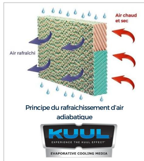
Avantages : Robustesse, faible coût d'installation, d'utilisation et d'entretien. Variateur de vitesse de 10 à 100% du débit d'air nominal. Alimentation en eau automatique par raccord rapide. Purge manuelle.
