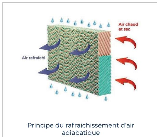
De série : Panneau cellulose haut rendement, pré-filtres lavables, télécommande radio ou filaire, purge automatique programmable, vitesse variable, arrêt automatique.
